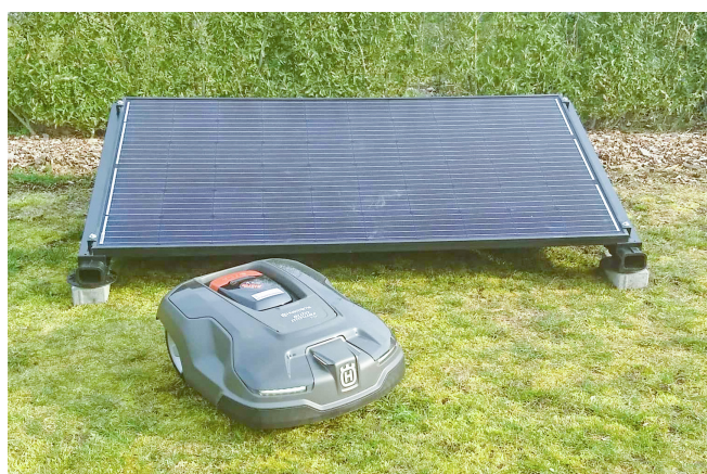
Opstilling af solcelleladestation til 2500m 2 græsareal.
