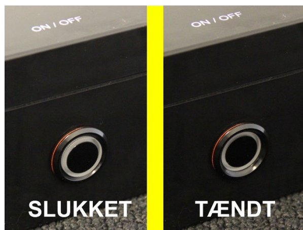
Sørg for at boksen er slukket ved at knappen er ude.
