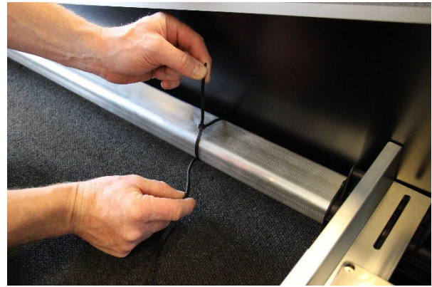
Kablet føres under bundprofilen. Det er vigtigt at trække kablet med en strips.
