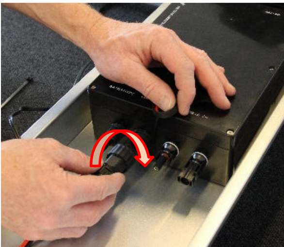
Specialkablet til robotens ladestation der følger med dette kit isættes i udgangen af ladeboksen. Stikket klikkes i og ringen drejes til højre, så stikket låser til boksen (= vandtæt). Pas på ikke at overspænde.
